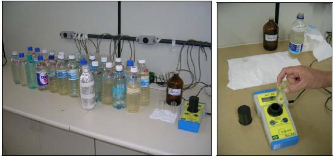
Figura 3.21 - Procedimento de leitura de turbidez em bateria de amostras. Fotos: OLIVEIRA F., 2006. Fonte: OLIVEIRA F., 2006.
