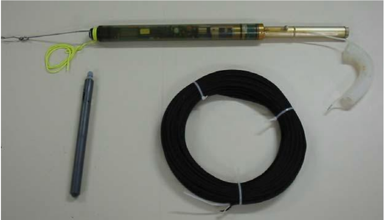
Figura 3.5 - Marégrafo de Pressão utilizado na determinação dos níveis de água nas estações maregráficas M5 e M8. Fonte: IME, 2003.
