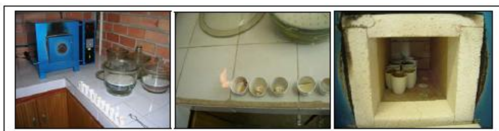
Figura 3.23 - procedimento de queima de matéria orgânica: (1) colocação das membranas em cápsulas previamente secas e pesadas; (2) queima com álcool; (3) queima em forno tipo mufla. Fotos: OLIVEIRA F., 2006.Fonte: OLIVEIRA F., 2006.
