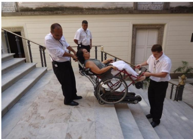
Figura 39: Equipamento de acoplamento de cadeira de rodas para ascender escadas.
