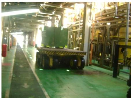
Figura 8 – *Trolley* de 18 t com caixa metálica, estacionado na via central da planta
