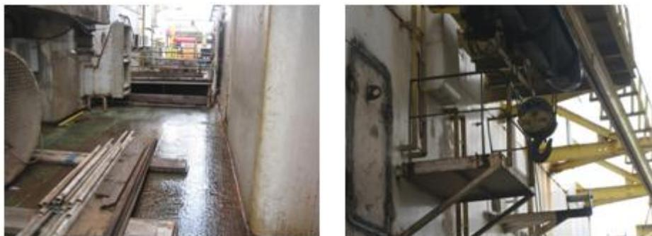
Figura 123 - Talha da gaiuta para praça de máquinas
