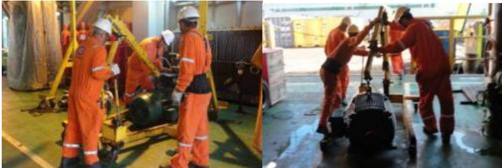
Figura 88 – Supervisor utiliza um *floor crane* para elevar e movimentar a válvula
