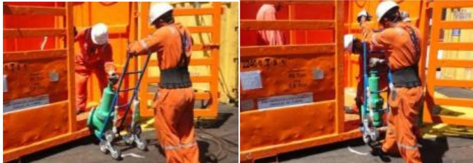
Figura 93 – Auxiliares usam o suporte inferior do carrinho para fazer alavanca
