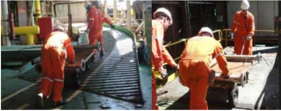
Figura 102 – Atrito com a rampa causa instabilidade na carga, mas equipe chega ao elevador
