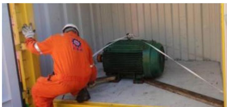
Figura 92 – Equipe coloca fitas e pedaço de madeira para proteger o equipamento
