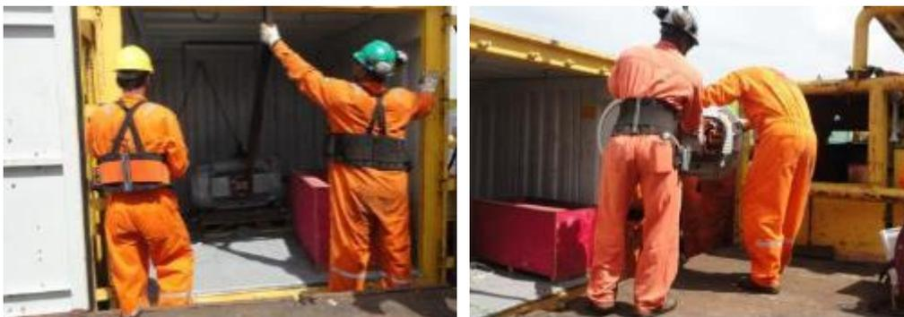
Figura 113 – Equipe utiliza guindaste e talha manual para retirar equipamentos de um contêiner
