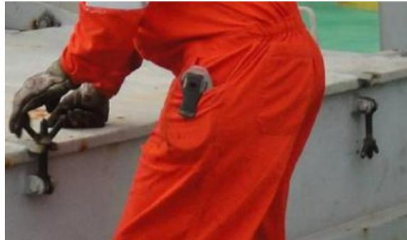
Figura 71 – Auxiliar abrindo uma das travas da gaiuta à esquerda e à direita, uma trava aberta
