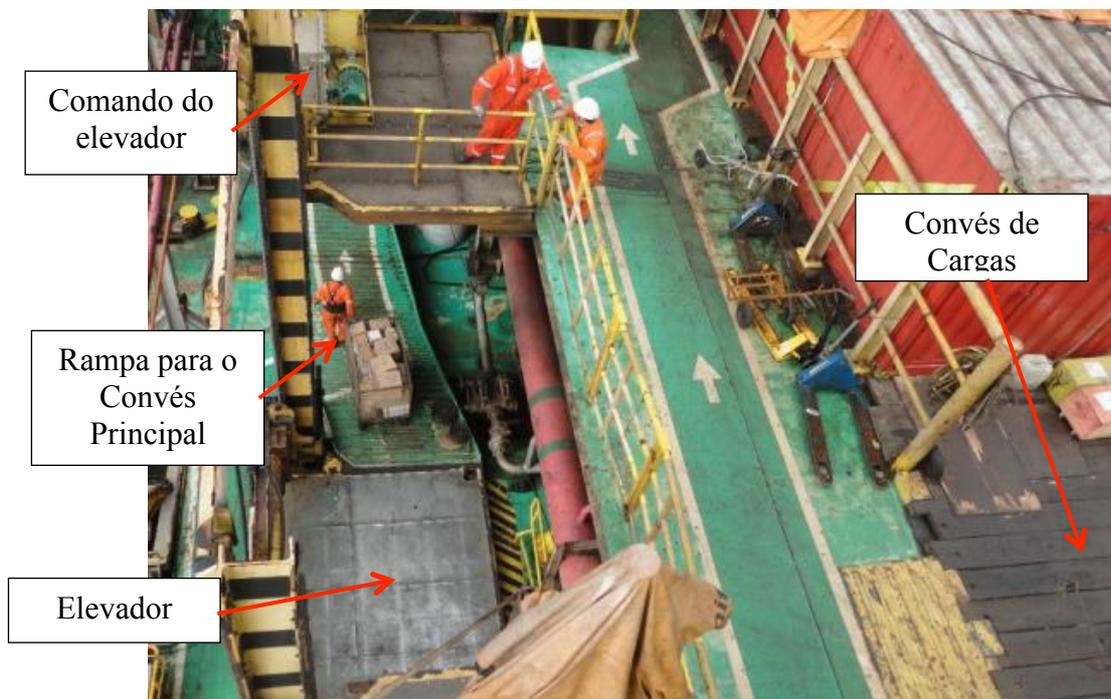
Figura 6 – Movimentação de itens para o almoxarifado com carrinho através do elevador
