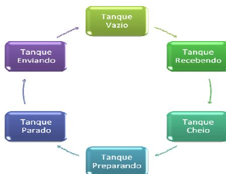
Figura 17. Diagrama com os estados dos tanques.
