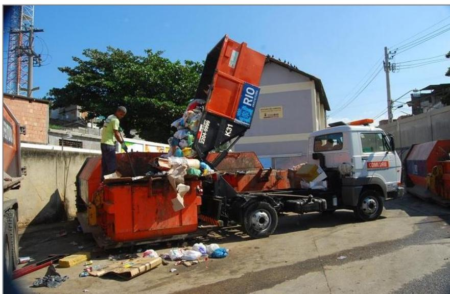
Figura 24 - Mini basculante de 3m<sup>3</sup>
