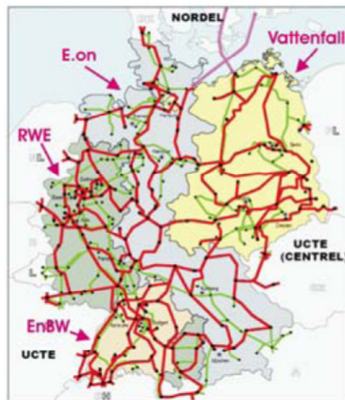
Figura 22: O sistema de transmissão da Alemanha e seus operadores (FONTE: LÓPEZ & ACKERMANN, 2008 : pag. 100)
