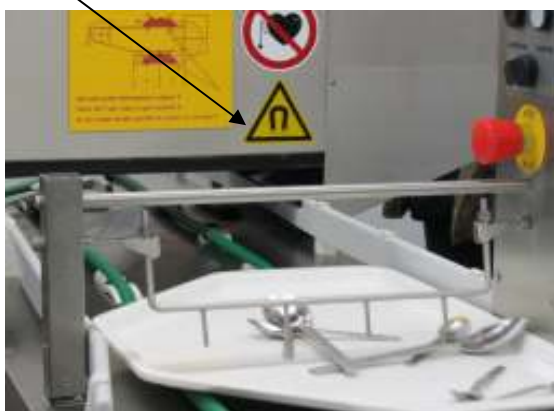
Figura 54: Máquina lavadora de louças com sistema de captação e separação de talheres
