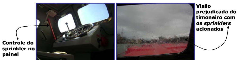
Figura 25: Melhoria no controle dos sprinklers .
