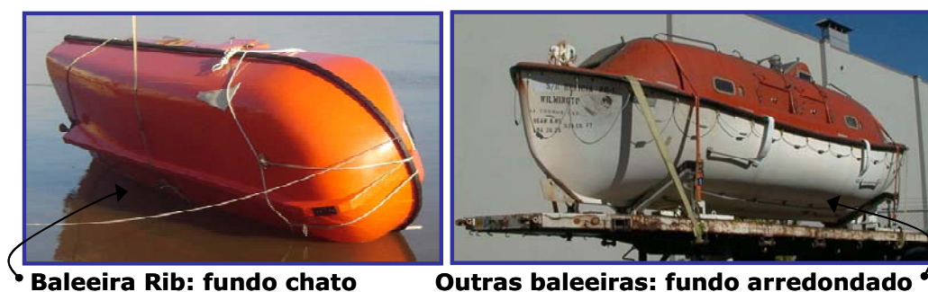
Figura 24: Melhoria no formato do casco.
