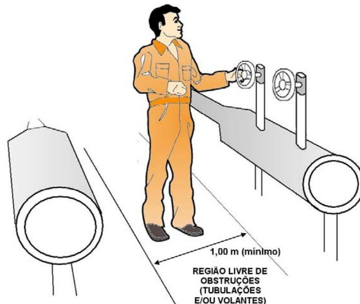
Figura 53 – Região de acesso aos volantes de válvulas entre lançadores e recebedores
