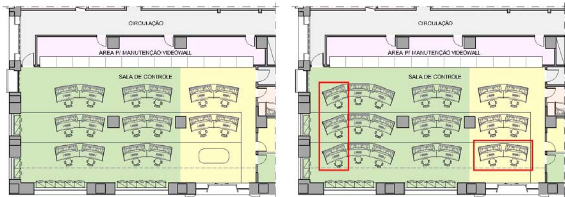
Figura 44 – Planta baixa sala de controle: opção 2 de layouts para dezesseis e vinte e um consoles (onze de julho)
